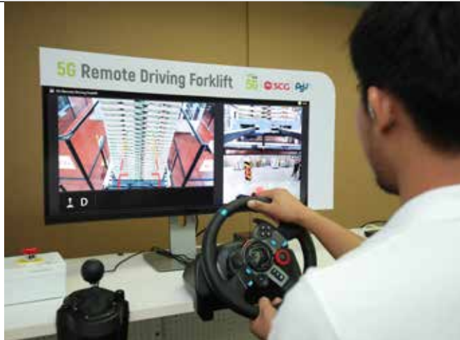
พนักงานกำลังทดสอบใช้งานจริง 5G ควบคุมรถยกผ่านทางไกล
